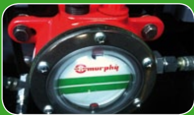
7 Sistema de manutenção do nível de diesel Mur-phy
